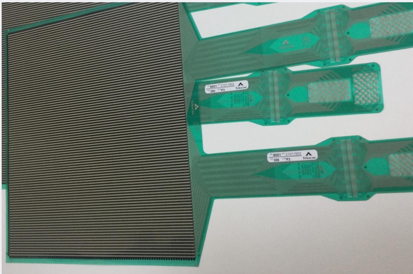
Для проведения экспериментальных исследований с целью более глубокого понимания процессов разрушения льда на наклонной грани морского сооружения лаборатории были поставлены широкие датчики высокого разрешения модели Tekscan® 8001. Датчик этой марки имеет матрицу 292.6 x 268.2 мм, число чувствительных элементов датчика составляет 8448 единиц. Подключение такого датчика осуществляется посредством двух контроллеров одновременно.
